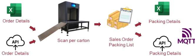
现在，**仓库 G** 可以通过将整个纸箱放入 RFID 扫描柜中，提供更快的入库检查。与手动逐个打开每个箱子进行对账相比，在使用 RFID 扫描柜的情况下，清单将在 2 秒内出现。如果有任何遗漏或过多发货的物品，清单将打印出来，并附上直接热转印标签，以便操作人员进一步检查。
